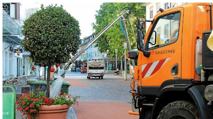
Unimog mit komfortabler Gießvorrichtung.
