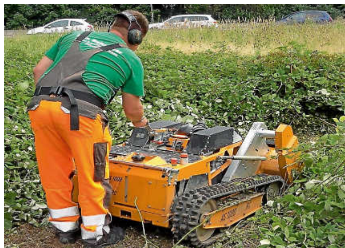
Die Mähraupe wird in schwer zugänglichen Bereichen eingesetzt.
