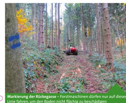
Markierung der Rückegasse – Forstmaschinen dürfen nur auf dieser Linie fahren, um den Boden nicht flächig zu beschädigen
